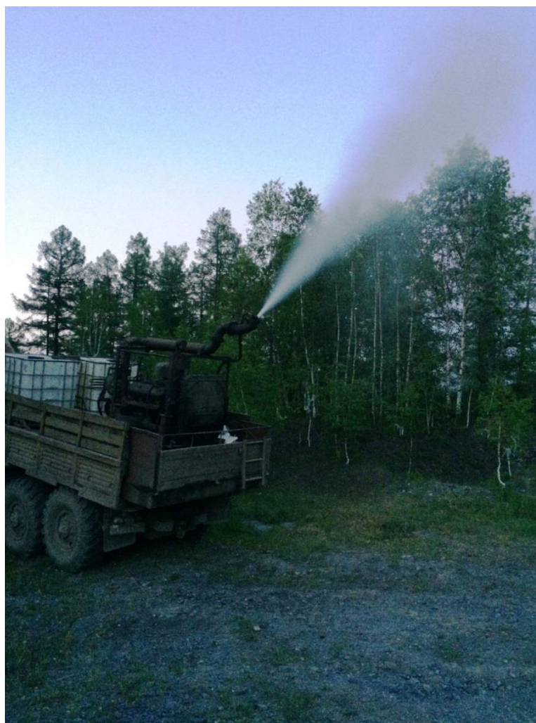
Рисунок 10. Полевые испытания с использованием аэрозольной установки ГАРД на базе автомобиля Урал-4320 (Республика Алтай, 2017 г.)
